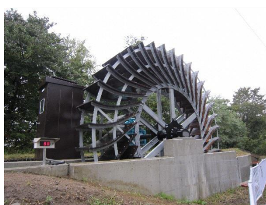
水の力を利用した小水力発電(明治百年記念公園) 発電出力 9.9kW
