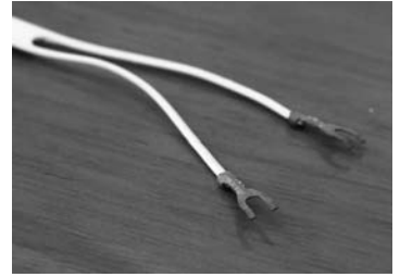
古いフィーダー線などでは、地デジを受信できない場合があります
