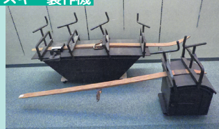
昭和7年から使用(当館蔵) スキー板を製作する道具です。内部にある円形の火鉢に炭を入れて火をおこし、その熱で板を曲げたり、歪みを調整したりして加工していたようです。 ※写真のスキーは完成品ですが、製作工程の参考としています。
