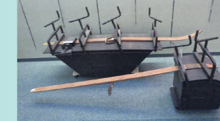
昭和7年から使用(当館蔵) スキー板を製作する道具です。内部にある円形の火鉢に炭を入れて火をおこし、その熱で板を曲げたり、歪みを調整したりして加工していたようです。※写真のスキーは完成品ですが、製作工程の参考としています。
