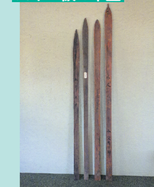
昭和7年から使用(当館蔵) スキー板を製作する際の見本です。見本の板には寸法などが書かれています。
