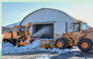
雪冷房りんどう培養育苗生産施設で冷却設備に活用するための雪入れ作業を実施(3月10日、雪氷貯蔵庫)
